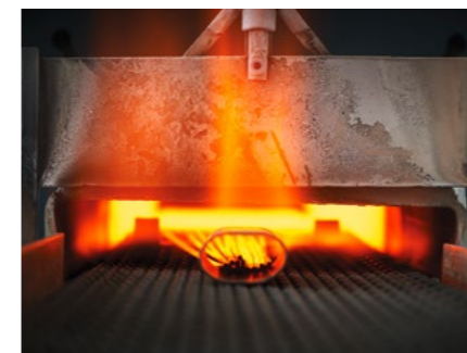
Thermische Vorbereitung des Mantelmaterials. Thermal preparation of sheath material.
