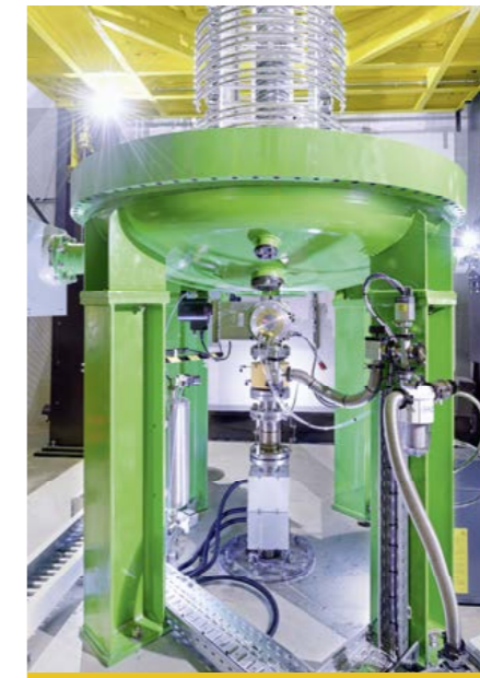
Elektronenbeschleuniger bei BGS
